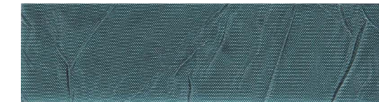
36 reflexe 45 % propustnost 23% absorpce 32%
