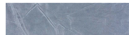
16 reflexe 57% propustnost 19% absorpce 24%
