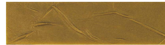
33 reflexe 34% propustnost 8% absorpce 58%
