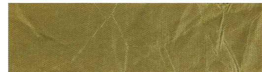
13 reflexe 41% propustnost 8% absorpce 51%
