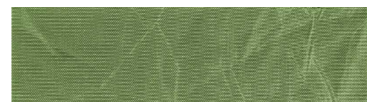
12 reflexe 53% propustnost 18% absorpce 29%
