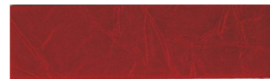
30 reflexe 28% propustnost 6% absorpce 66%
