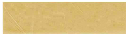
23 reflexe 52 % propustnost 36% absorpce 12%
