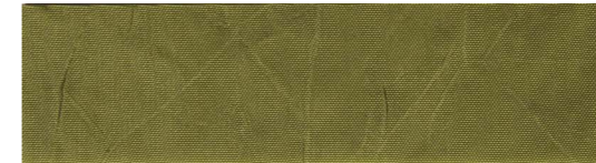
32 reflexe 44% propustnost 22% absorpce 34%
